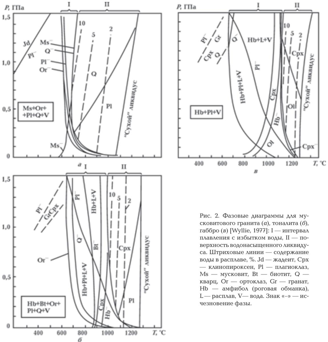
Рис. 2. Фазовые диаграммы для мусковитового гранита (а), тоналита (б), габбро (в) [Wyllie, 1977]: I — интервал плавления с избытком воды, II — поверхность водонасыщенного ликвидуса. Штриховые линии — содержание воды в расплаве, %. Jd — жадеит, Cpx — клинопироксен, Pl — плагиоклаз, Ms — мусковит, Or — ортоклаз, Gr — гранат, Hb — амфибол (роговая обманка), L — расплав, V — вода. Знак «-» — исчезновение фазы.
