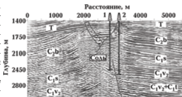
Рис. 2. Сейсмический разрез через Бакейский шток в ДДВ, полученный в результате глубинной преломки миграции Кирхгофа.
