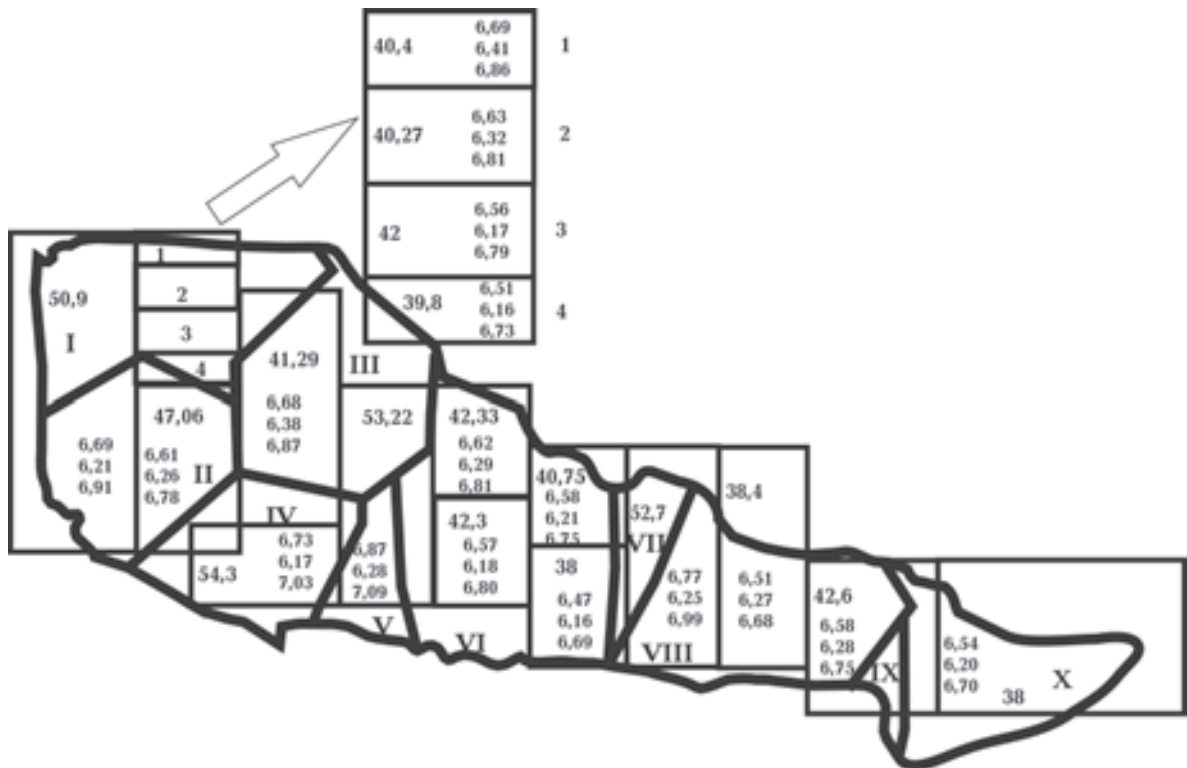
Рис. 3. Блок-схема осредненной модели земной коры УЩ, где представлены глубина залегания поверхности раздела М (км), а также значения средних скоростей (сверху вниз, км/с) в интервале земная поверхность — граница М, 0—15 км — поверхность раздела М: I — Волынский мегаблок, II — Подольский мегаблок, III — Росинский мегаблок, IV — Бугский мегаблок, V — Голованевская шовная зона, VI — Ингульский мегаблок, VII — Криворожско-Кременчугская шовная зона, VIII — Среднеприднепровский мегаблок, IX — Орехово-Павлоградская шовная зона, X — Приазовский мегаблок.
