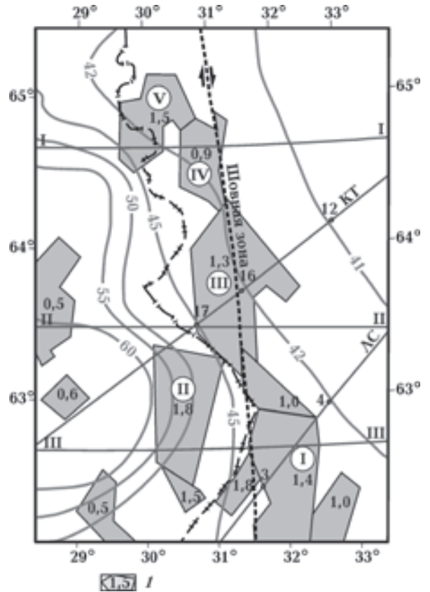
Рис. 3. Схема глубины залегания раздела М, км: 1 — проекции на поверхность М среднеинжекоровых источников магнитных аномалий, цифры — значения намагниченности, А/м. Цифры в кружках — глубинные источники магнитных аномалий (I — Толвоярвинская, II — Восточно-Финская, III — Ребольская, IV — Костомукшская, V — Вокнаволоцкая). Другие условные обозначения см. на рис. 2.
