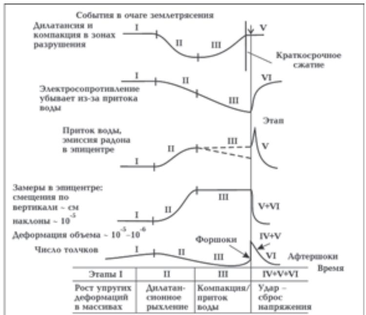
Рис. 8. Стандартная сводка предвестников землетрясений по К. Шольцу со шкалами времени и расстояний (см., например, [Rice, 1979; Райс, 1982]). Здесь показан этап краткосрочного сжатия (перехлеста).
