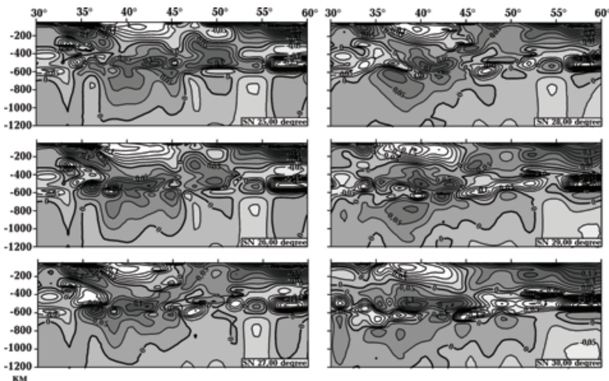
Рис. 2. Вертикальные долготные ( $25^{\circ}$ — $30^{\circ}$  в. д.) сечения трехмерной  $P$ -скоростной модели мантии района исследований. Сечение изолиний  $\Delta V_p$  через  $0,025$  км/с. Темно-серым и серым цветом показаны относительно высокоскоростные неоднородности, светло-серым и белым — относительно низкоскоростные.
