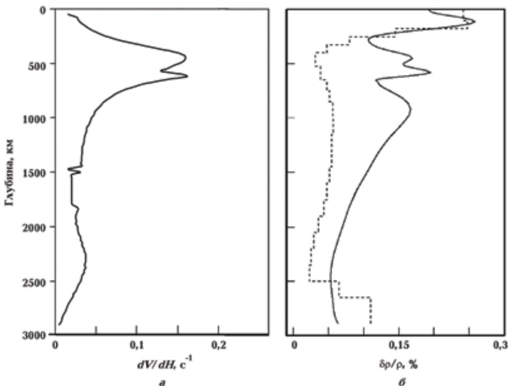
Рис. 7. Изменение градиента  $dV_p/dH$  до глубины 2900 км под центральной частью Черноморской впадины, полученное согласно использованной  $P$ -скоростной модели мантии (а), и изменение относительной плотности с глубиной (по [Forte, Mitrovica, 2001]), полученное из сейсмических моделей [Grand, 1997] (пунктирная линия) и [Ekström, Dziewonski, 1998] (сплошная линия) (б).
