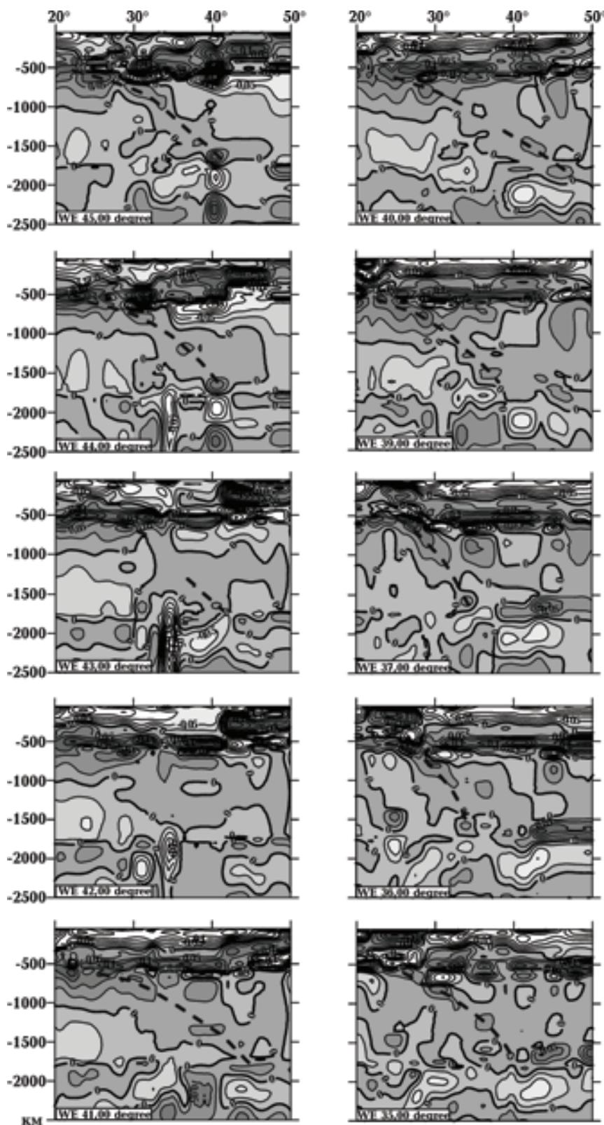
Рис. 3. Вертикальные широтные ( $35\text{--}45^{\circ}$  с. ш.) сечения трехмерной  $P$ -скоростной модели мантии района исследований. Штрихпунктиром отмечены относительно высокоскоростные наклонные слои. Условные обозначения см. на рис. 2.
