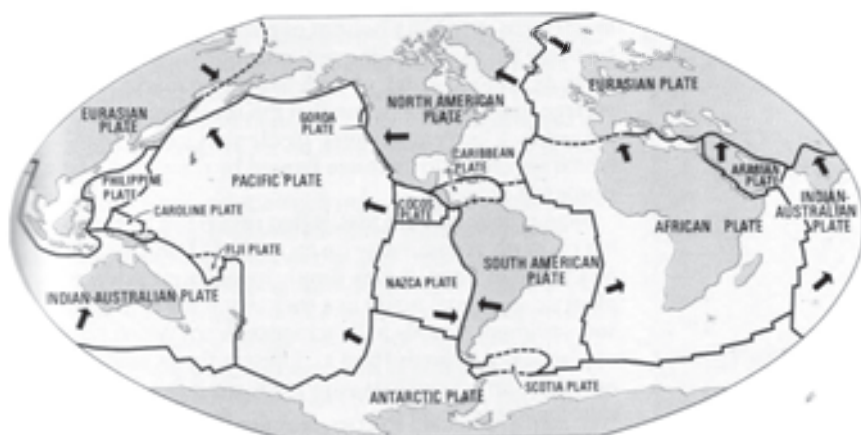
Рис. 9. Направления дрейфа современных тектонических плит (по Р. Дитцу и И. Холдену, 1972).
