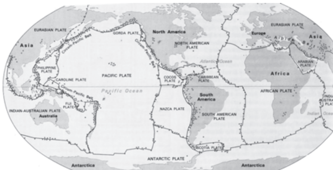
Рис. 1. Крупные землетрясения приуроченные к границам дрейфующих тектонических плит.
