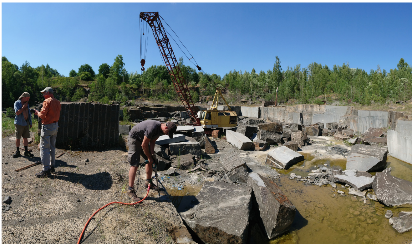
Рисунок 3.1. Приклад відбору зразків анортозитів способом буріння на занедбаному кар'єрі місця відбору № 4.
