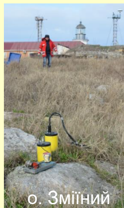
1 – універсальні сейсмічні станції, 2 – сейсмічні датчики, 3 – додаткові акумулятори, 4 – зовнішній GPS, 5 – радіоканал, 6 – USB кабель передачі даних.
