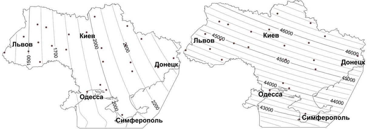
Рис.3.3.2 Значения компонент нормального магнитного поля Земли V_{IGRF} для территории Украины на эпоху 2000 года: а) индукции V ; б) склонения D ; в) наклонения I ; г) северной составляющей V_X ; д) восточной составляющей V_Y ; е) вертикальной составляющей V_Z .
