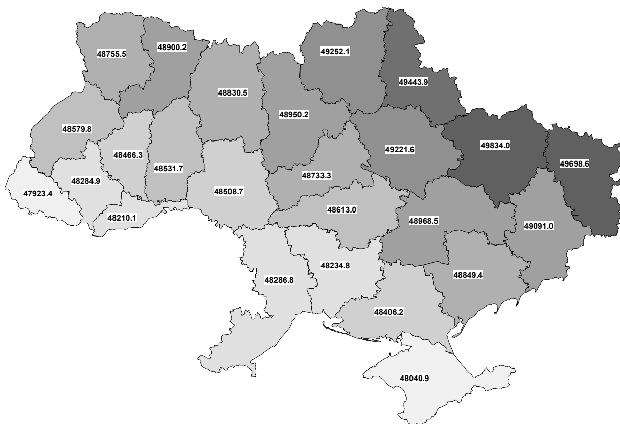
Рис.4.7.2. Средние значения модуля индукции магнитного поля B для областей Украины и АРК за 1961 г.
