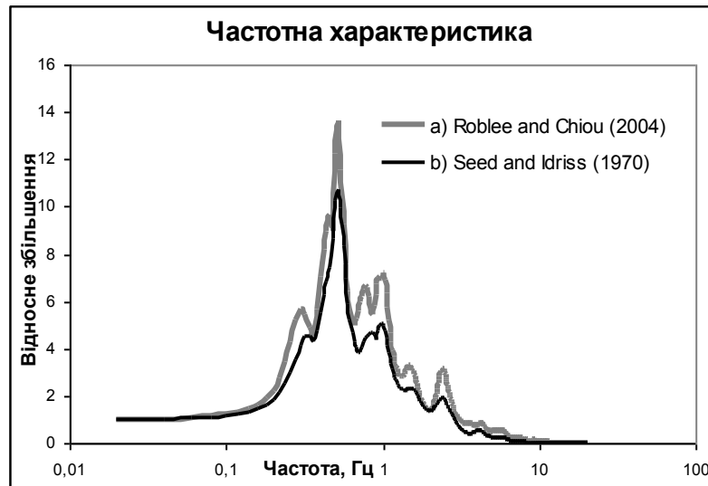
Рис. 1. АЧХ ґрунтової товщі під будівельним майданчиком по вул. Березняківська, 30 в Києві з врахуванням нелінійних властивостей для пісків з робіт: а) [Roblee and Chiou, 2004]; б) [Seed, Idriss, 1970]
