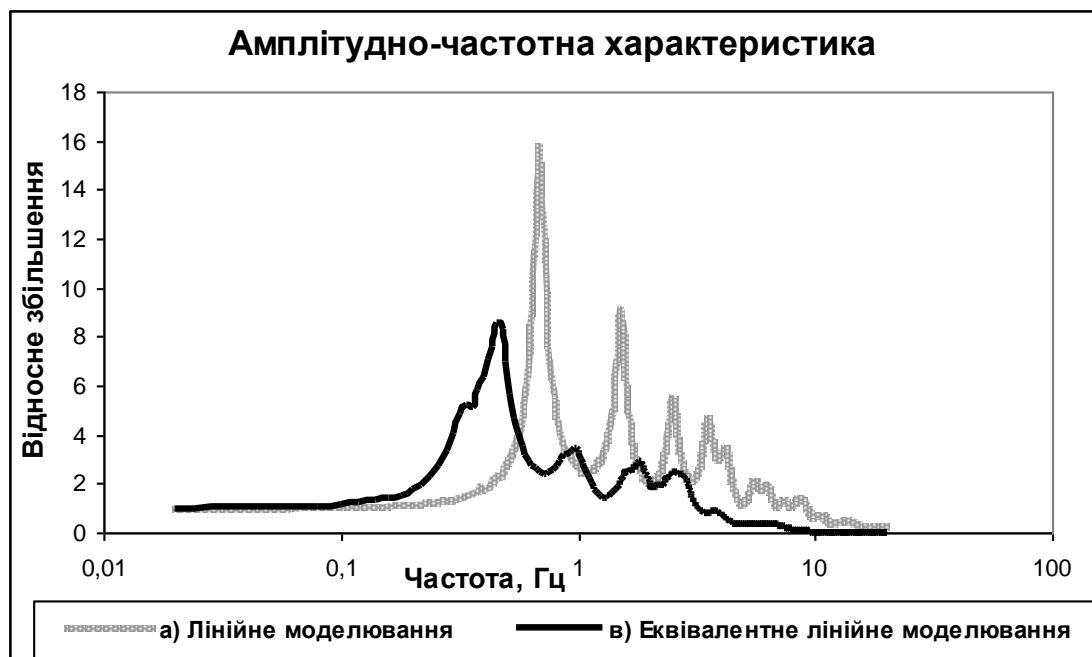
Рис. 4.5. Обвідні серії АЧХ ґрунтового середовища під будівельним майданчиком на перетині вулиць Червоногвардійської та Краківської в Києві отримані: а) лінійним моделюванням, в) еквівалентним лінійним моделюванням з використанням програмного комплексу PROSHAKE.
