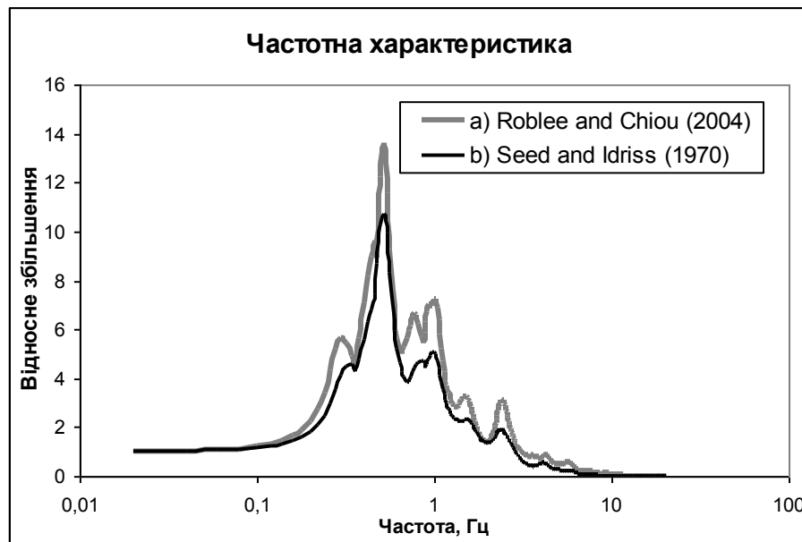
Рис. 3.15. АЧХ ґрунтової товщі під будівельним майданчиком по вул. Березняківська, 30 в Києві розраховані з врахуванням нелінійних властивостей для шарів ґрунту складених пісками за даними: а) [Roblee and Chiou, 2004]; б) [Seed, Idriss, 1970]
