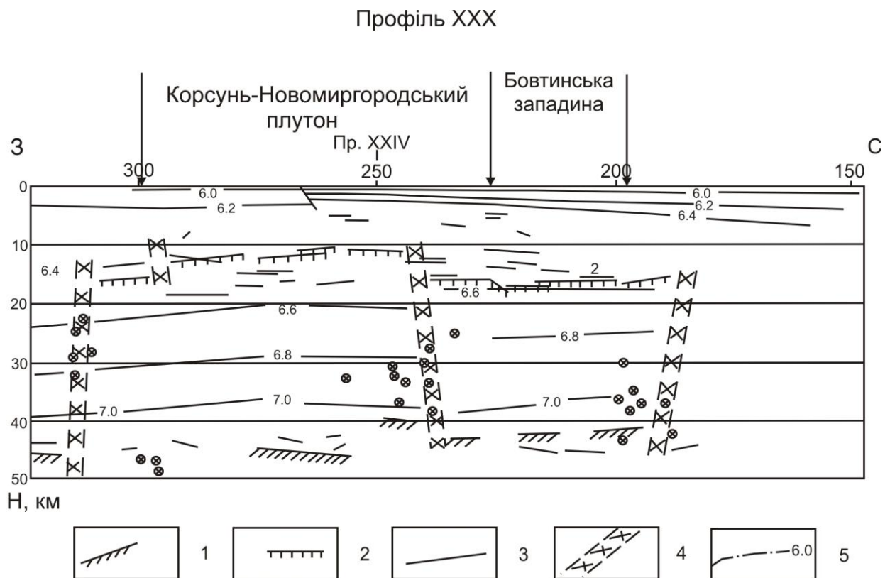
Рис 1.4. 1 – поверхня розділу М; 2 – поверхня K_2 ; 3 – відбиваючі площадки в земній корі та верхній мантії; 4 – глибинні розломи; 5 – ізолінії швидкостей.
