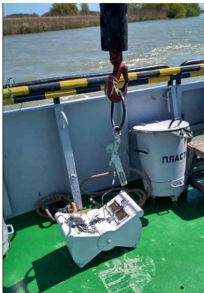
Рис. 4.25 Робота з дночерпаком Петерсена на палубі
