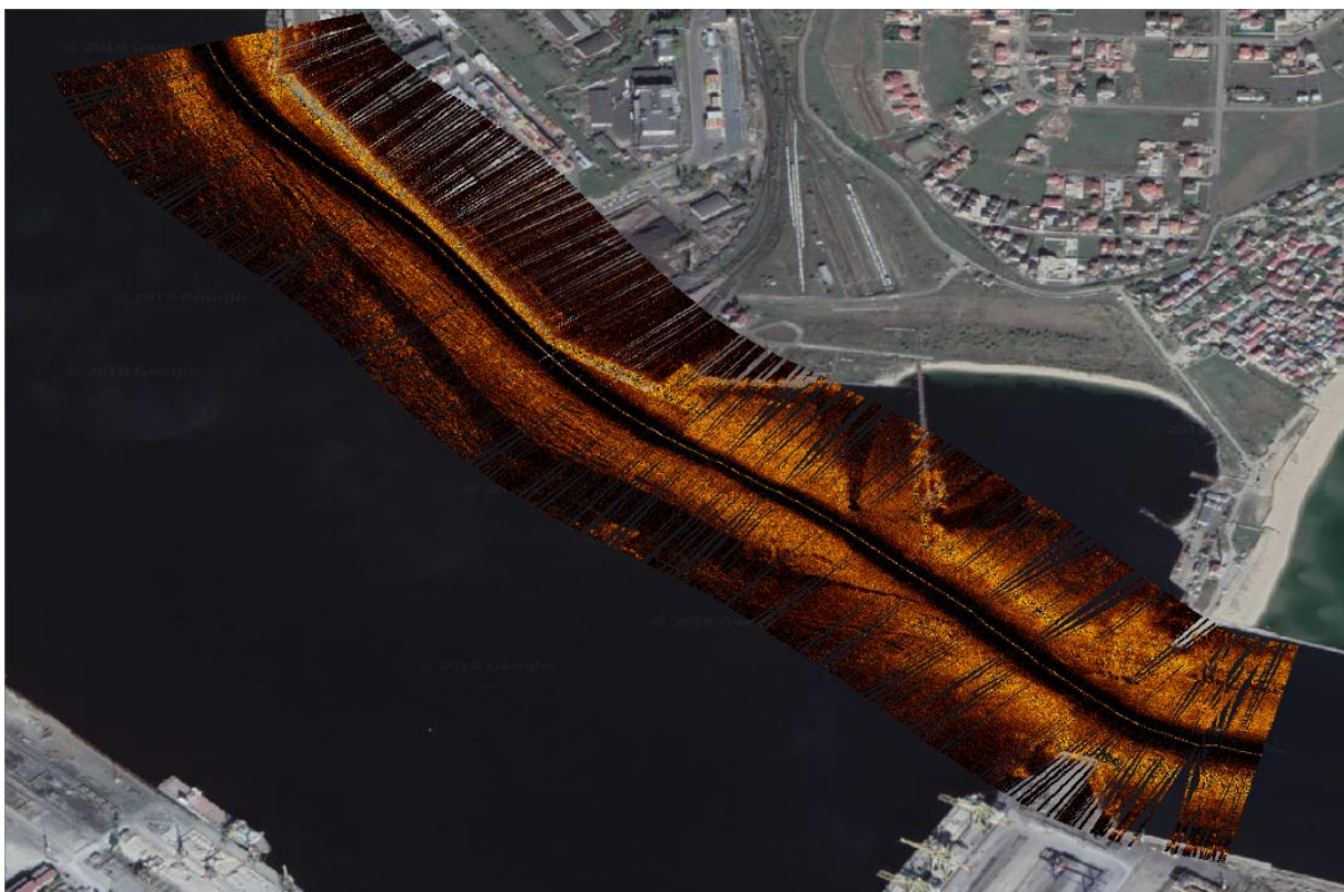
Рис. 4.17 Гідроакустична зйомка підхідного каналу та гідротехнічних споруд порту
