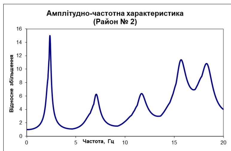
Рис. 6.4. Частотна характеристика моделі ґрунтової товщі інженерно-геологічного районів району № II (Ташлицька гребля), виділеного в межах території розміщення основних споруд Ташлицької ГАЕС
