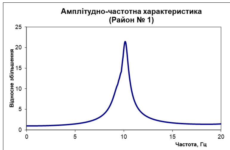
Рис. 6.3. Частотна характеристика моделі ґрунтової товщі інженерно-геологічного районів №1 (вододільна рівнина), виділеного в межах території розміщення основних споруд Ташлицької ГАЕС
