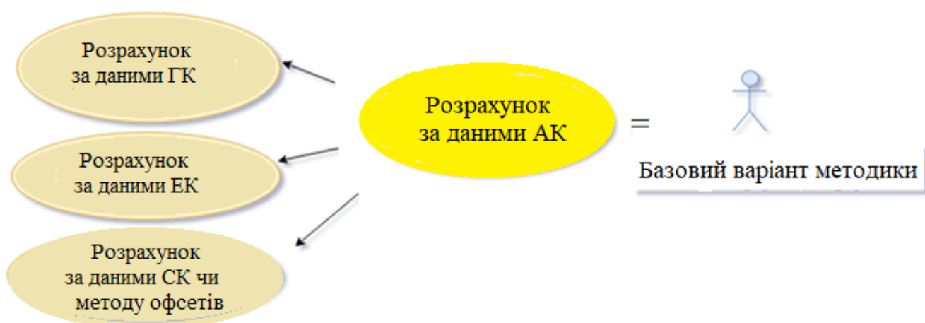
Рис. 4.1 Апробовані варіанти методики з використанням даних різних каротажів для отримання швидкостей поздовжніх хвиль, потрібних у прогнозуванні за базовим варіантом методики (за даними АК)
