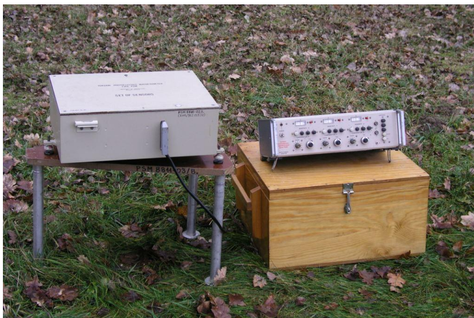
Рис.4.4. Цифрова магнітоваріаційна станція PSM-8911
