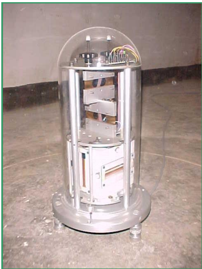
Рис. 4.7. Трьохкомпонентна магнітоваріаційна станція FGE
