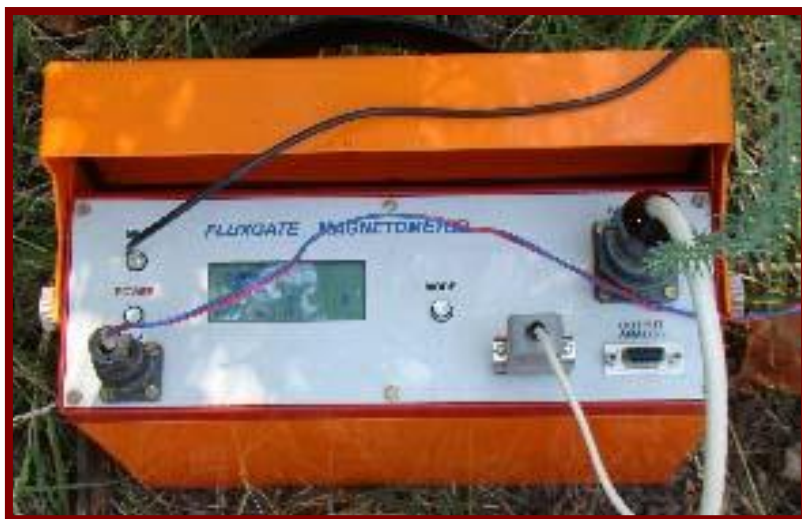
Рис. 4.2. Магнітоваріаційна станція LEMI -008
