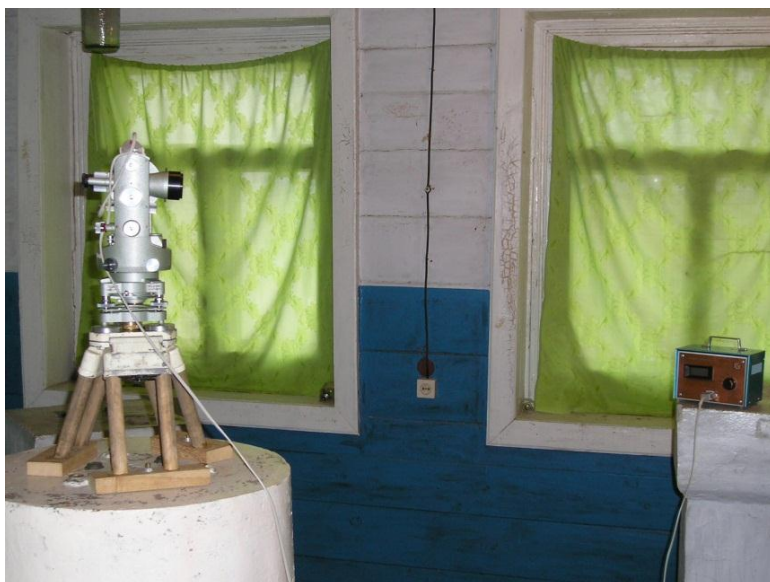
Рис. 4.6 DI fluxgate Tavistock з ферозондом FLM1/B
