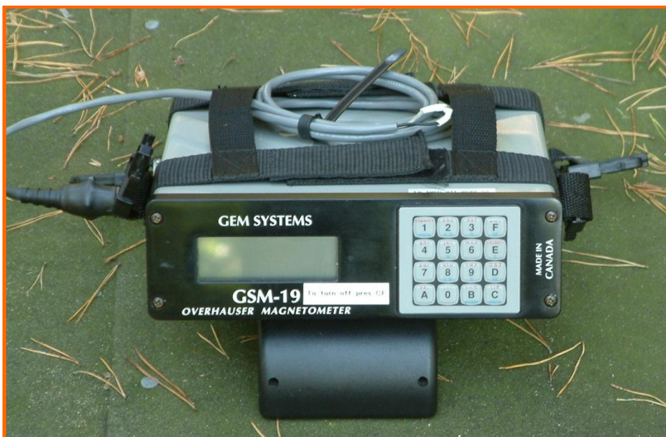
Рис.4.9. Протонний оверхавзівський магнітометр GSM19
