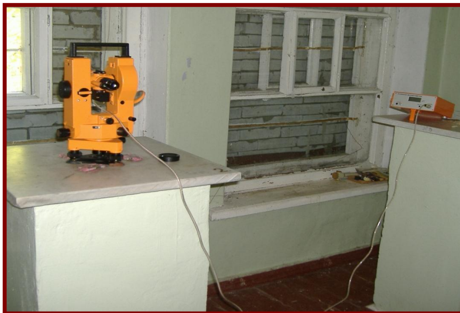
Рис.4.3. Сучасний DI fluxgate магнітометр на геомагнітній обсерваторії «Київ»
